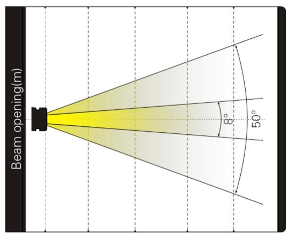
Distance(m) 8°Diameter(m) Ф0.38 Ф0.76 Ф1.14 Ф1.52
